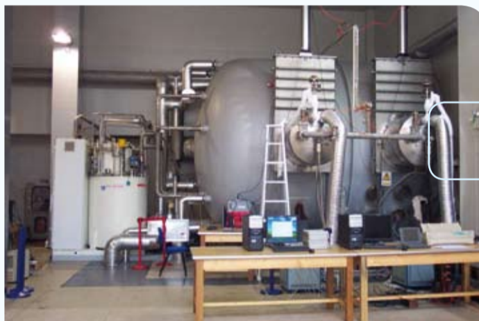
Un premier HELIAL, produisant 700 W à 20 K, (Cryoscope 30 p.4-5) avait été livré en 2004 en Chine pour la chambre de simulation spatiale de SISE (Shanghai Institute for Satellite Engineering). Le prochain HELIAL produira 1 000 W à 20 K pour la chambre de simulation spatiale de 100 m³ (8mx4mx4m) du CAST. An earlier HELIAL, producing 700W at 20K, (Cryoscope 30 p.4-5) was delivered to China in 2004 for the space simulation chamber belonging to SISE (Shanghai Institute for Satellite Engineering). The next HELIAL will produce 1,000W at 20K for CAST's 100m³ (8mx4mx4m) space simulation chamber.
