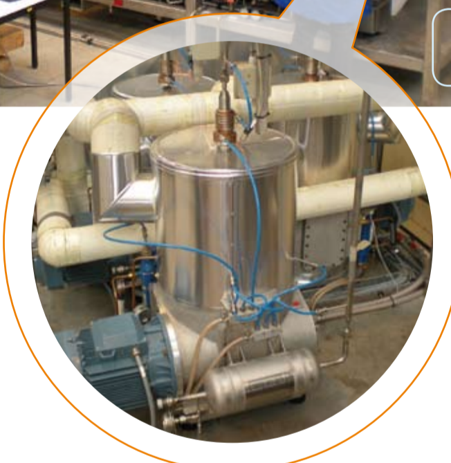
En gros plan, un des pulse tubes du prototype de démonstration, en test sur le site des Techniques Navales de la DGA à Toulon. Close up, one of the pulse tubes prototypes, tested at the Naval Techniques site of the DGA at Toulon.
