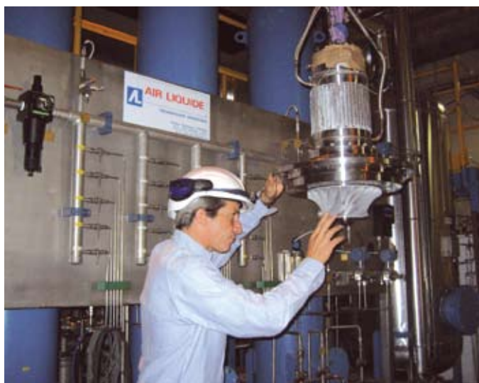
Au CERN, dernières vérifications avant intégration d'un compresseur froid, en septembre 2006.
